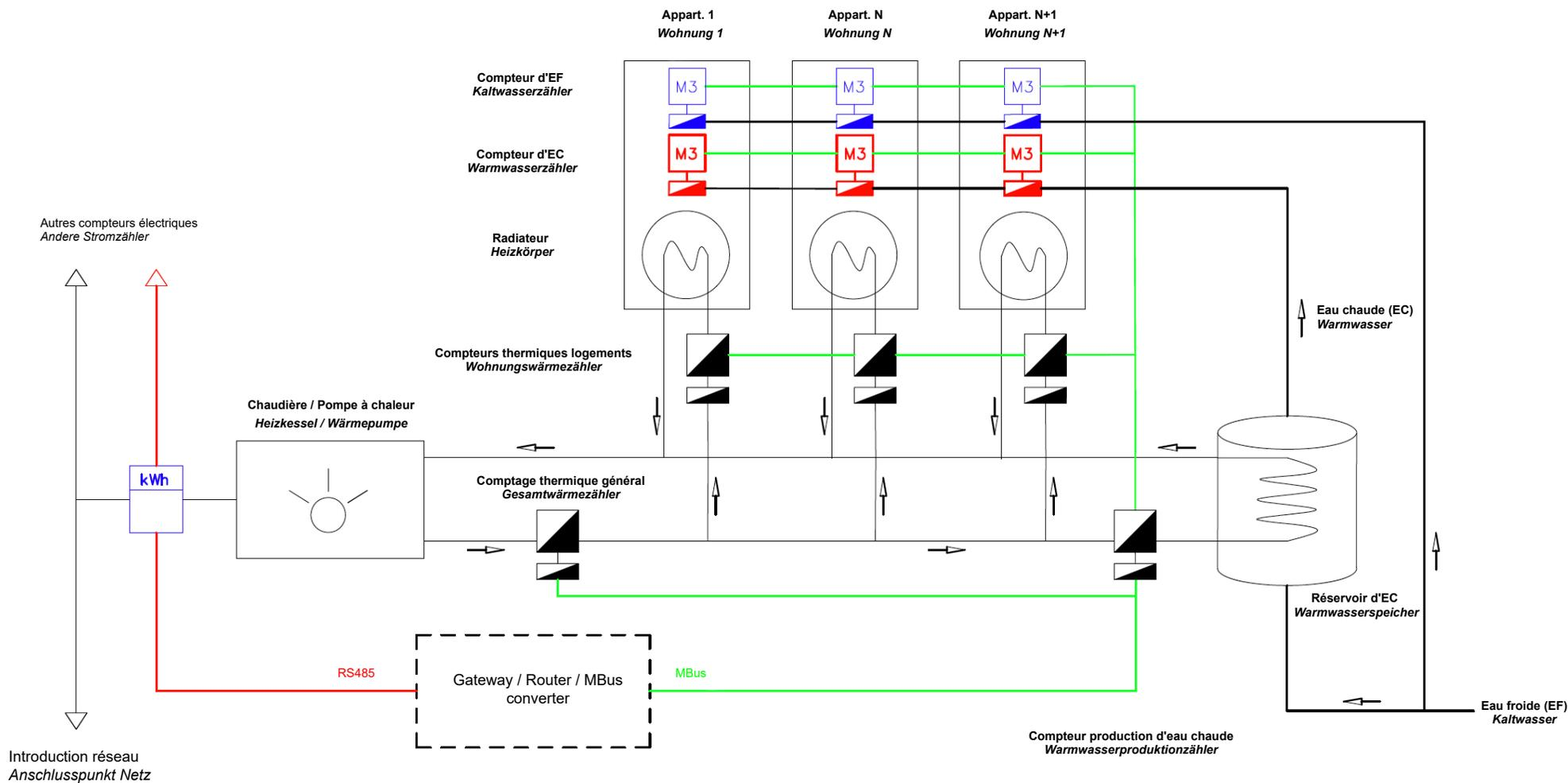
**Climkit Heating - Schéma de principe / Prinzipschema - 05/07/21**
