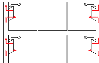
Aerazione con finestre ad apertura automatizzata
