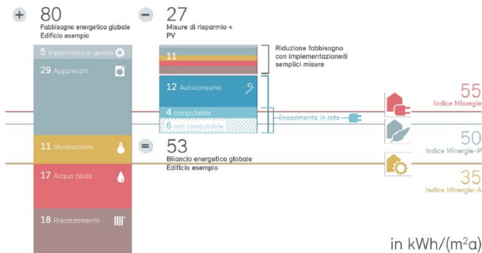
Figura 2: Esempio di bilancio e indice Minergie per una casa plurifamiliare, con i requisiti dell'indice Minergie per lo standard Minergie base e Minergie-P. I valori standard richiesti sommati, sono confrontati con i risparmi conseguiti grazie a misure di efficienza relative ai singoli fabbisogni e alla produzione energetica di impianti fotovoltaici, obbligatori per le nuove costruzioni. Tutti i valori di energia finale sono ponderati mediante i fattori di ponderazione Minergie.
