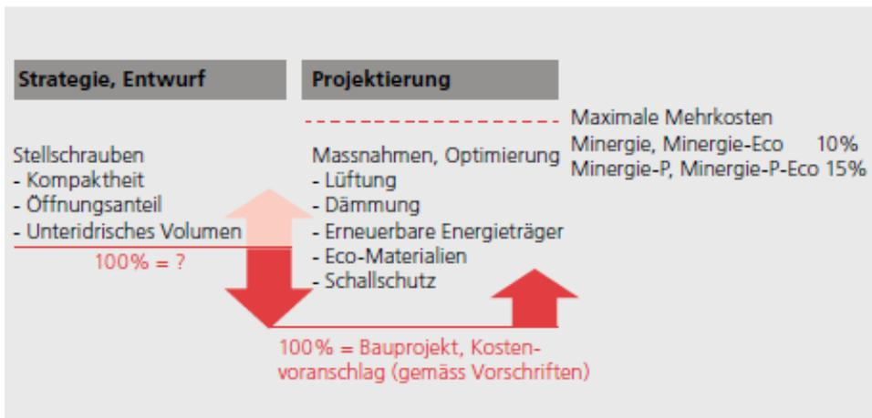
Abbildung 7: Investitionskosten in den Phasen Entwurf und Projektierung
